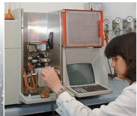
Eine der Grundvoraussetzungen für eine professionelle Bauzustandsanalyse: die Ermittlung des Salzgehaltes der Mauerwerksprobe.
