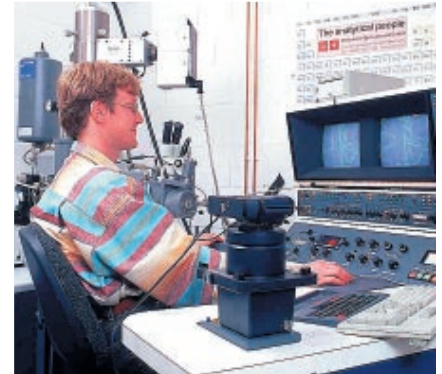
Selbst kniffligste Mauerwerksschäden können erkannt und behoben werden: die Untersuchung mit einem Raster-Elektronen-Mikroskop.
