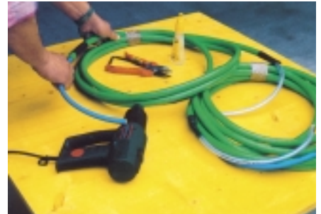
Das wichtigste Element des Predimax-Injektionssystems zur Herstellung von wasserundurchlässigen bzw. kraftschlüssigen Fugen ist der Predimax-Injektionsschlauch. Das Predimax-Schlauchsystem sieht als Fugendichtung planmäßig eine Injektion vor, die den gesamten Fugenbereich erfäßt, ohne dass der Beton angebohrt werden muß.
