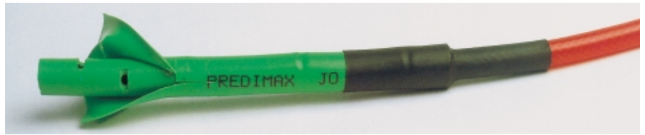
Das wichtigste Element des Predimax-Injektionssystems zur Herstellung von wasserundurchlässigen bzw. kraftschlüssigen Fugen ist der Predimax-Injektionsschlauch. Das Predimax-Schlauchsystem sieht als Fugendichtung planmäßig eine Injektion vor, die den gesamten Fugenbereich erfäßt, ohne dass der Beton angebohrt werden muß.
